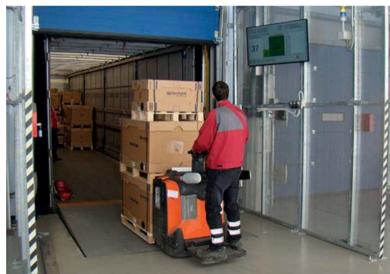
Presso una delle baie di carico il riempimento è monitorato da un video che informa in tempo reale sulla correttezza delle operazioni. I carrelli accedono al vano a normale velocità operativa
