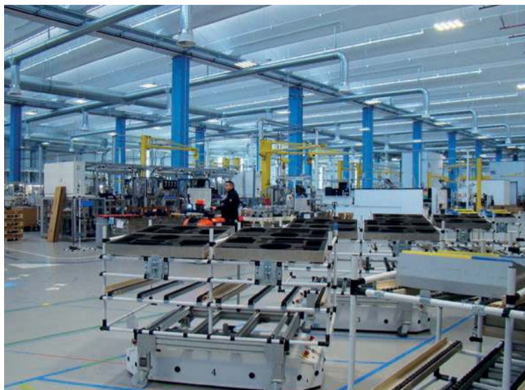
I componenti sono stoccati il più possibile vicino alle isole di assemblaggio al fine di minimizzare i tempi di spostamento coordinati dai software e materialmente eseguiti da AGV, carrelli elevatori o trattorini
